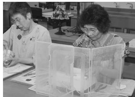
切り出したガラスを削って形を整えています
