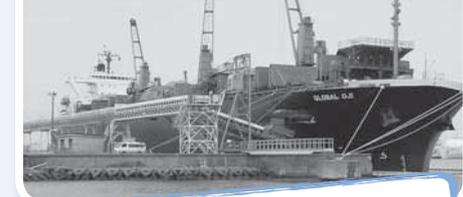
木材チップ(紙の原料になる木材片)を運ぶ船。木材チップは軽く、かさが大いため、船倉が高いのが特徴です。チップは、ベルトコンベヤーで直接貯蔵ヤードに送ります。
