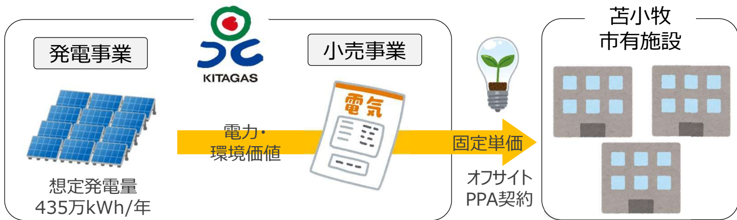
図. 市有施設への電力供給スキーム
