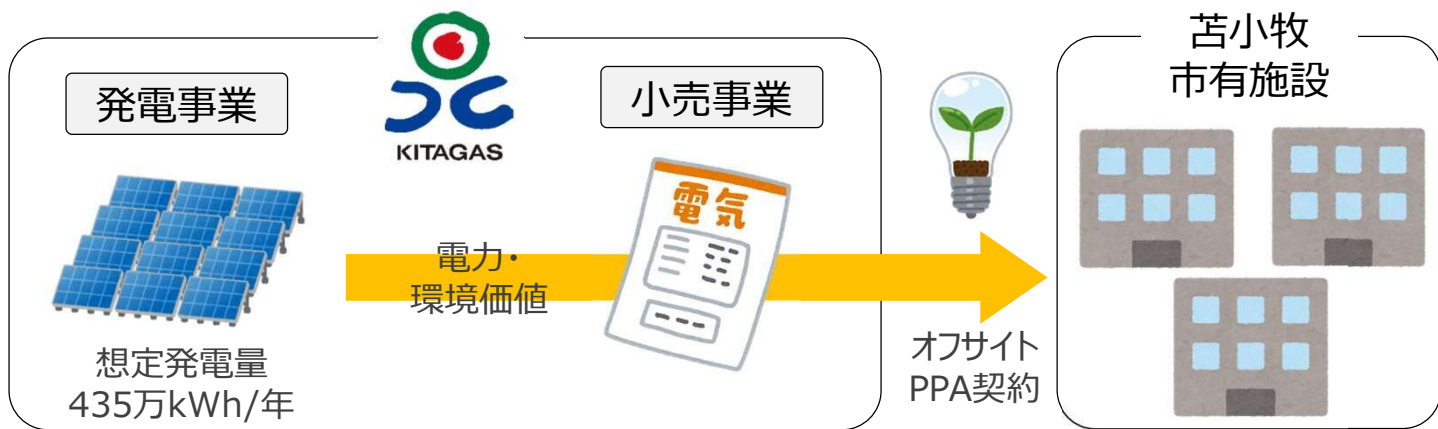
図. 市有施設への電力供給スキーム
