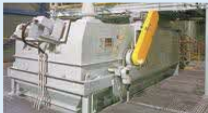
⑦ アルミ選別機 じしゃくや電気の力でアルミを集めます。
