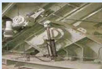
③ 一次破砕機 しげんとなるものを分けやすくするため、回る2つの刃を使い、ごみをくたきます。
