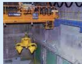
② 不燃(粗大)ごみピット / 粗大・不燃ごみクレーン ごみピットにたまったごみは、クレーンでつかみ、一次破砕機へ送ります。
