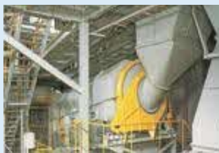
⑥ 回転式選別機 回転する機械の中で、燃やせるごみ・アルミ・燃やせないごみを、それぞれの大きさごとに分けます。
