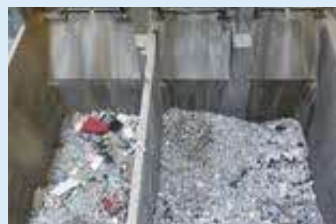
② 不燃(粗大)ごみピット / 粗大・不燃ごみクレーン ごみピットにたまったごみは、クレーンでつかみ、一次破砕機へ送ります。
