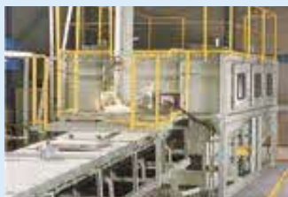
⑤ 磁選機 強い力のじしゃくを使い、ごみの中から鉄類を集めます。
