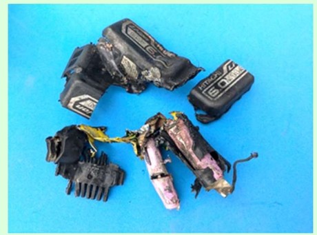
発火して変形したバッテリー
