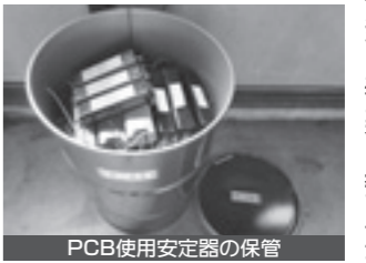
PCB使用安定器の保管
