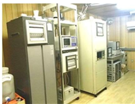
【 市内大気汚染測定局 6 局で 24 時間常時測定 】
