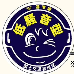
低騒音型建設機械に指定されたものについては、左図のような「低騒音型建設機械ステッカー」が添付されています。
