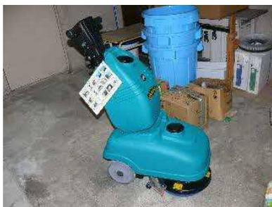
バッテリー式自動床洗浄機
