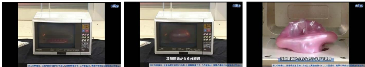
写真3 NITEによる電子レンジで温めるタイプのゆたんぽを加熱しすぎて破裂した事故の再現映像
