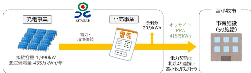
図. 市有施設への電力供給スキーム
