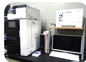
高速液体クロマトグラフ分析装置 洗剤（界面活性剤）成分を測定します。
