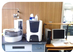
全有機炭素分析装置 水道水中に含まれる有機物を測定します。
