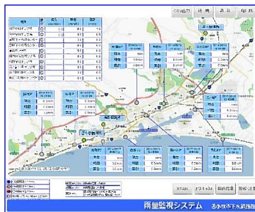
雨量監視システム
