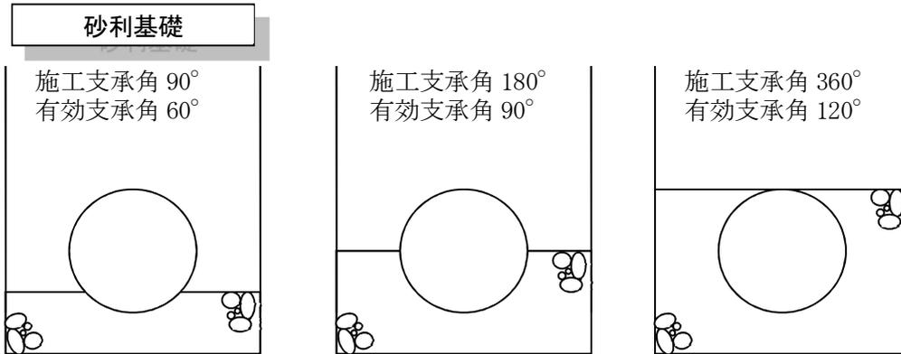
※ 基床部厚さを管外径×0.20 で求め、最小 100mm、50mm 丸めとし、管側部厚さを支承角より求め、50mm 丸めとする（各寸法は「苫小牧市標準下水道標準図集参照」）。
