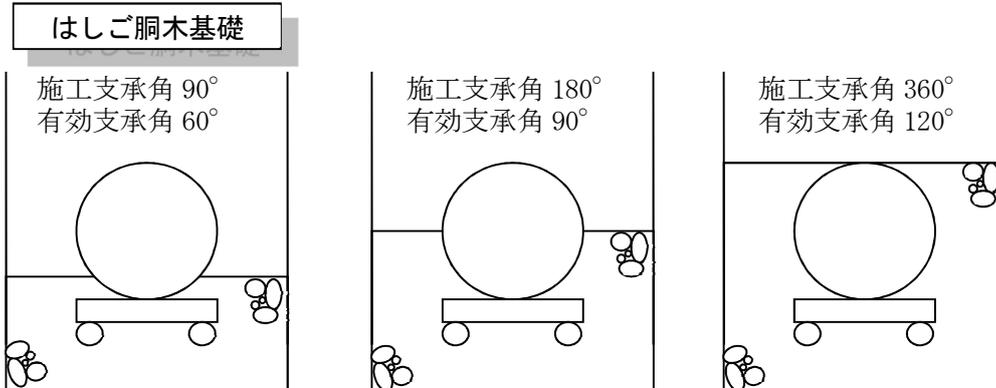
※ はしご胴木基礎下部厚さを 10 c m とし（基床分厚さは丸めない）、管側部厚さを支承角より求め、50mm 丸めとする（各寸法は「苫小牧市標準下水道標準図集参照」）。
