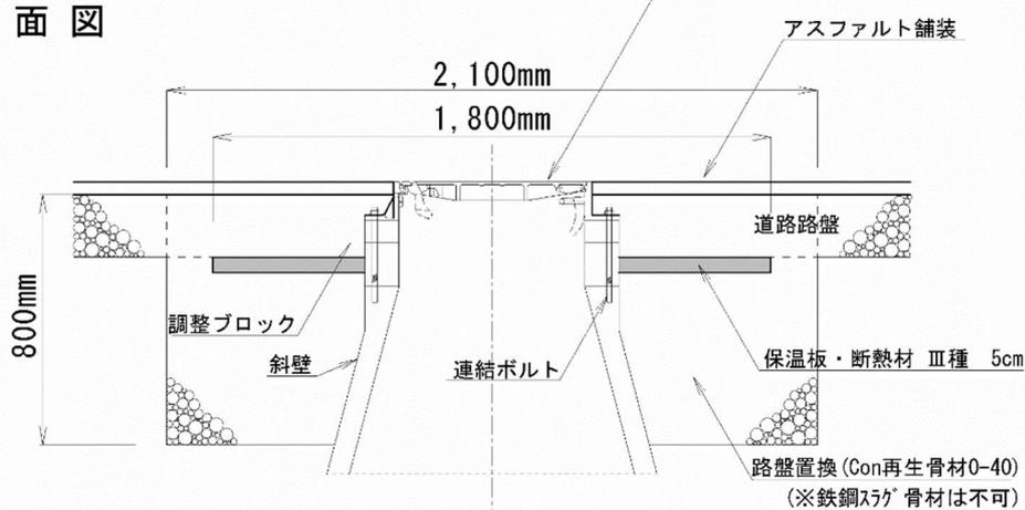
※「鉄鋼スラグ路盤材」は、水により固結し、pHが高いため、再掘削の施工や周辺環境への影響を考慮し、マンホール周囲の凍上防止材としては使用しないこと。
