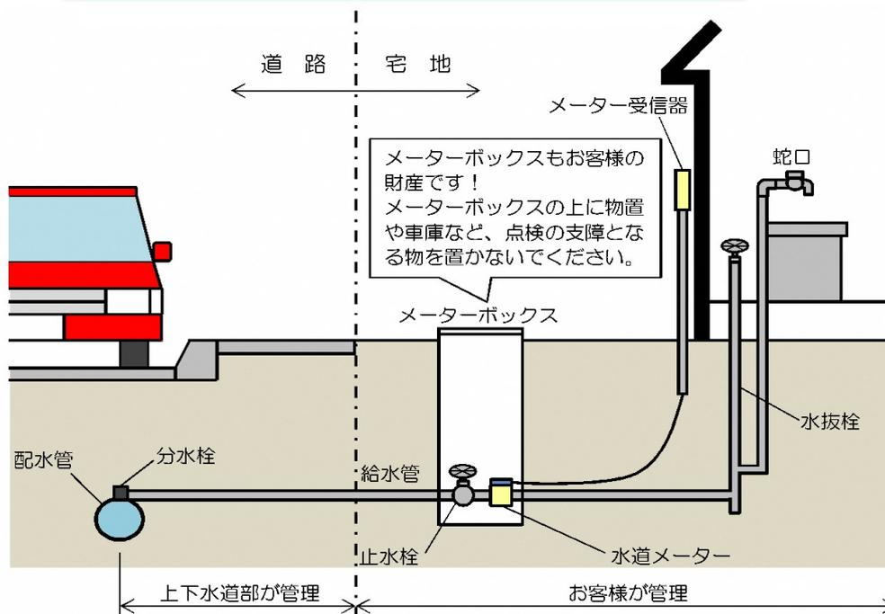
道路に埋設された水道管（配水管）から分かれて、家庭まで引き込まれた分水栓から蛇口までを「給水装置」と呼びます。
