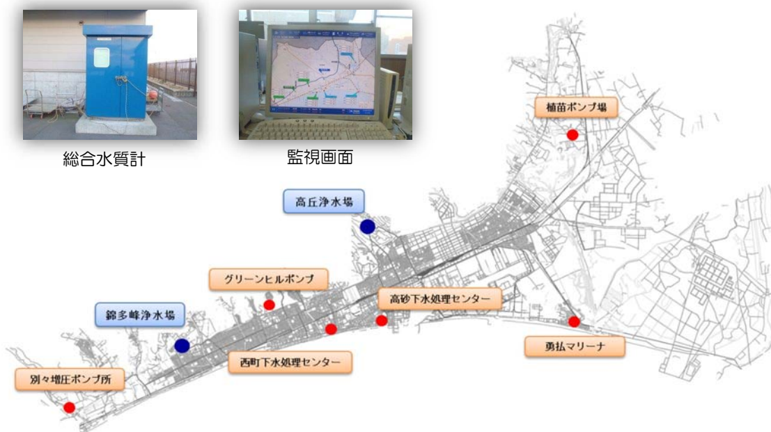
図 3-39 残留塩素濃度監視システム
