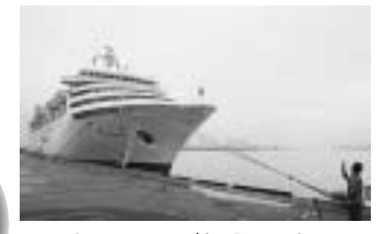
大型クルーズ船「ふじ丸」 全長167m・全幅24m
