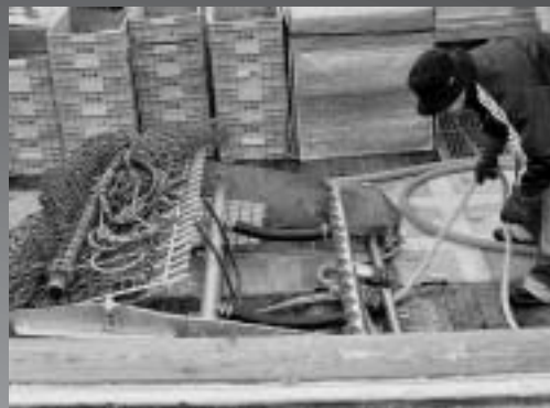
ホッキ漁に使われる噴流式桁網漁具。船上からホースで海水を送り、砂の中にある貝を掘り返して獲る。
