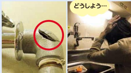
凍結で穴の開いた水道管 凍結すると大変なことに
