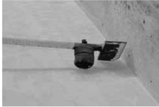
②整氷車で削った後、リンク各所にある30箇所程度のポイントに穴を開け、ノギスで1/10mm単位の氷厚測定をする。
