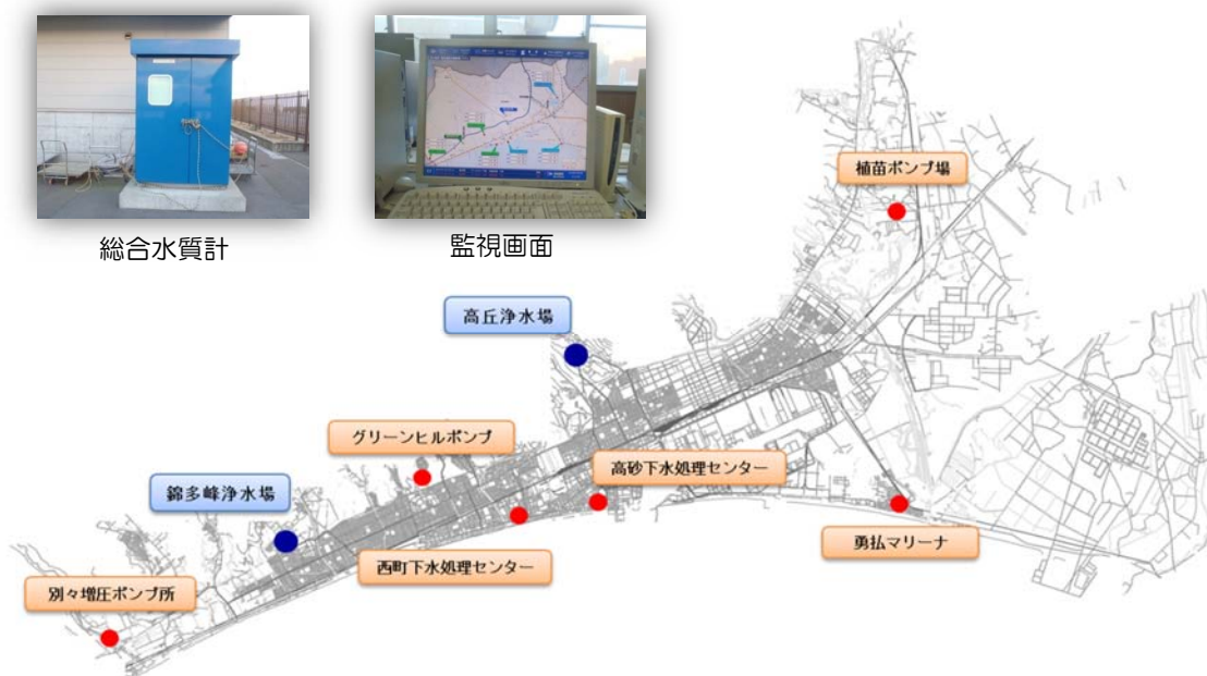
図3-39 残留塩素濃度監視システム
