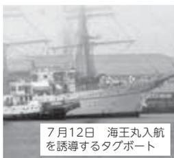
接触事故などが起こりやすい岸付近では、タグボートを利用します。タグボートとは、狭い港内で接触事故などを起こさないように大型船を押ししたり引いたりするボートのことです。安全・確実に着岸や離岸できるように、ワイヤーなどでけん引したり、タグボートに古タイヤなどをつけて、直接押ししたりもします。
