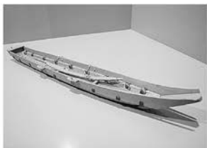
◀板綴船(イタオマチブ)の模型 中央に見える丸木舟に波除けの板を張っている
