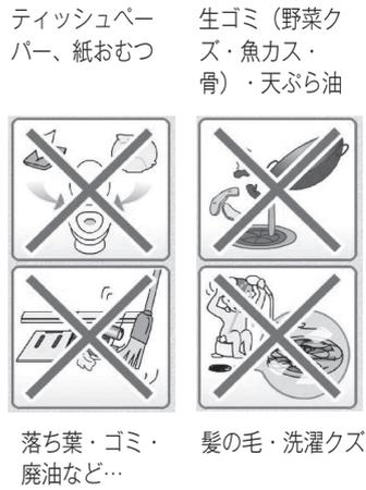
下水道の大敵は「油」。下水道管を詰まらせる原因です。また、水洗トイレ用の紙を使う、自然に優しい洗たく洗剤を使う、髪の毛を流さない、雨水桝に落ち葉やゴミなどを捨てない、といったこともぜひ心がけましょう。
