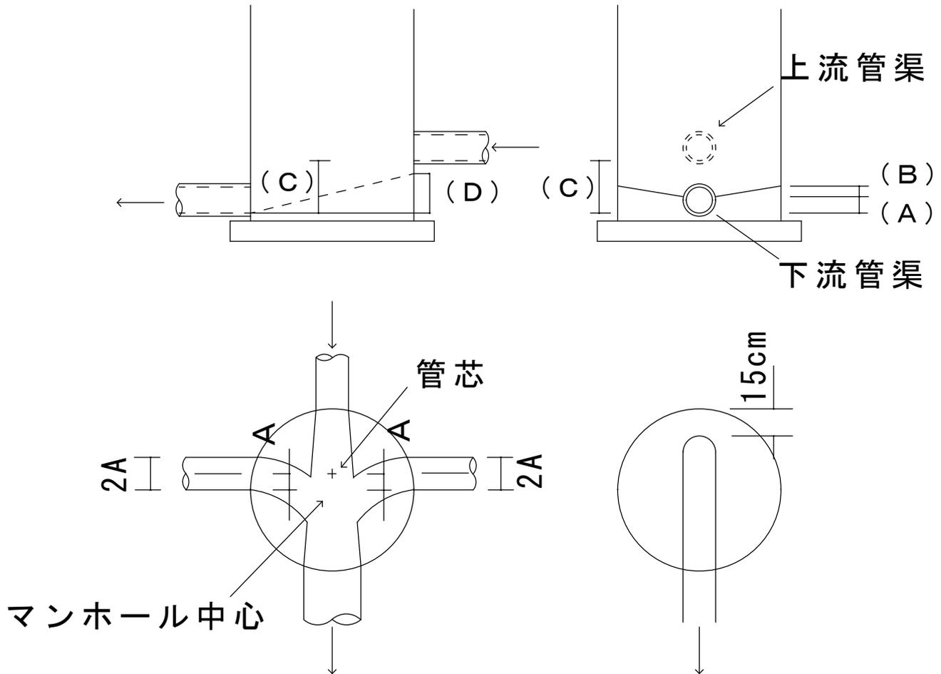
インバート高は、(A) : 下流管径の1/2とする。
