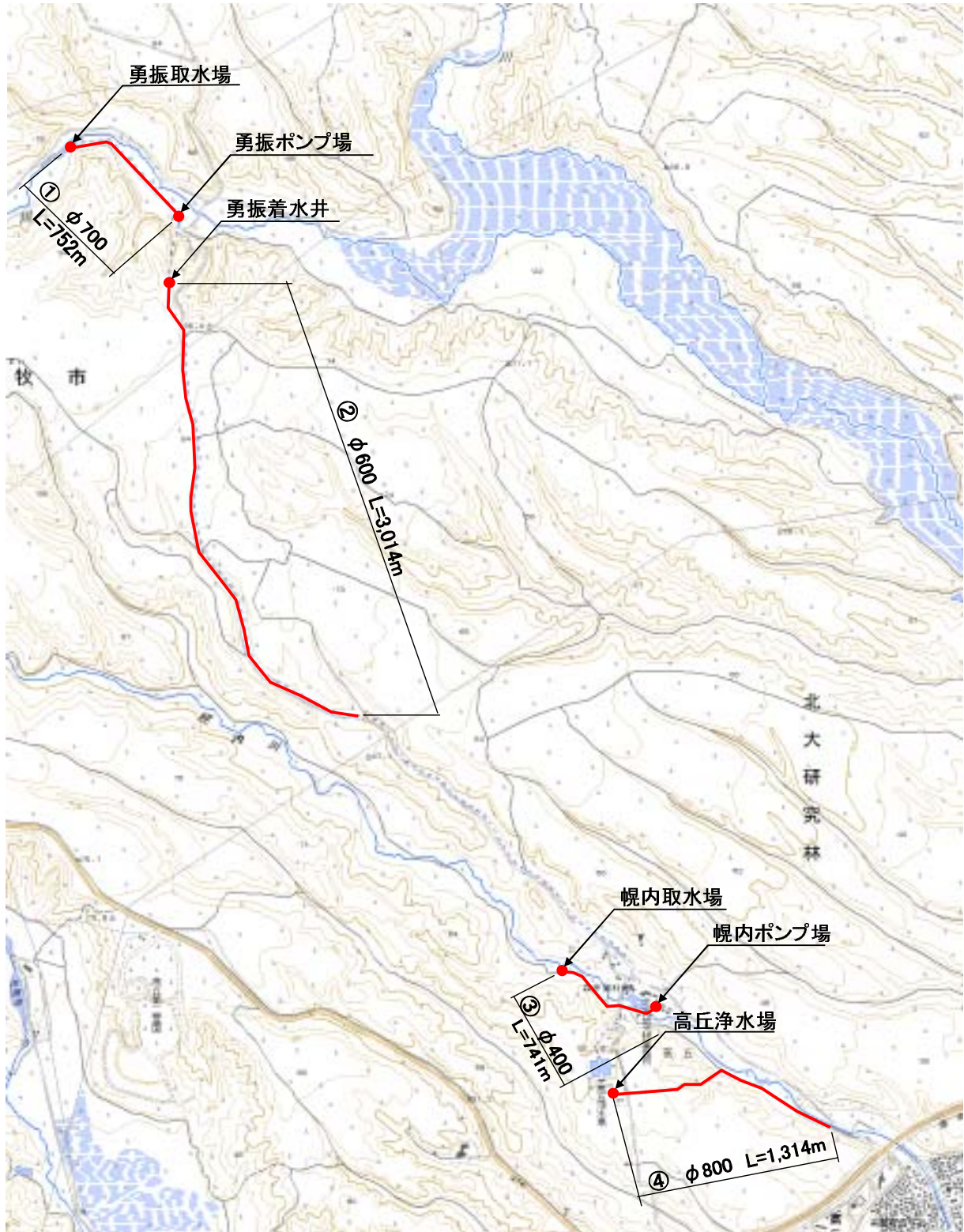
高丘浄水場系の布設替え対象老朽管
