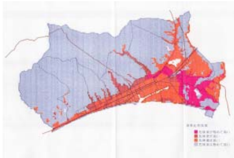
苦小牧直下の地震による液状化発生の可能性
