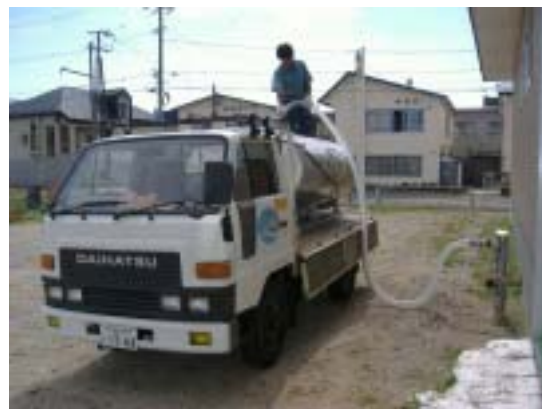
アルミ製給水タンク
